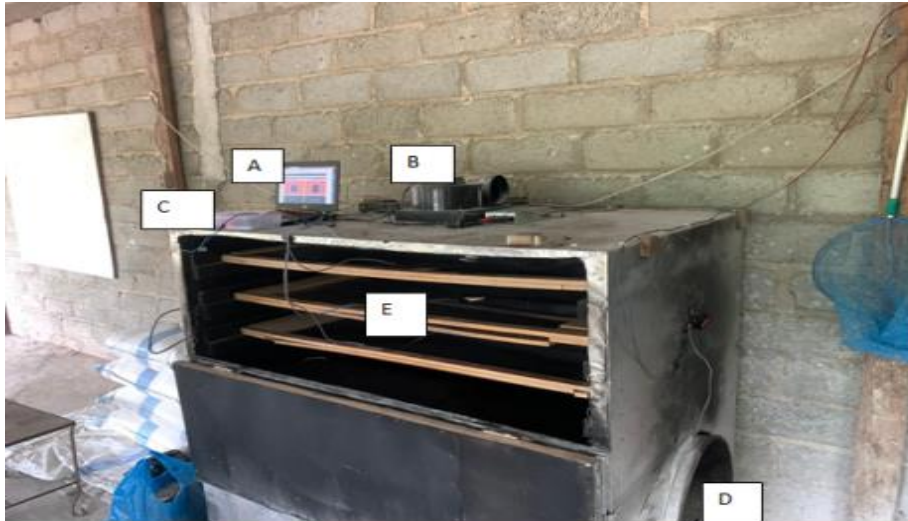
Gambar 1. Desain alat pengering Gapek dengan sistim jarak jauh
