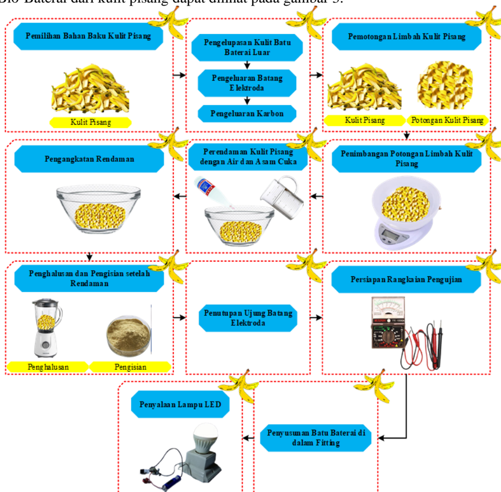
Gambar 3. Prosedur Pembuatan Bio-Baterai dari Kulit Pisang
