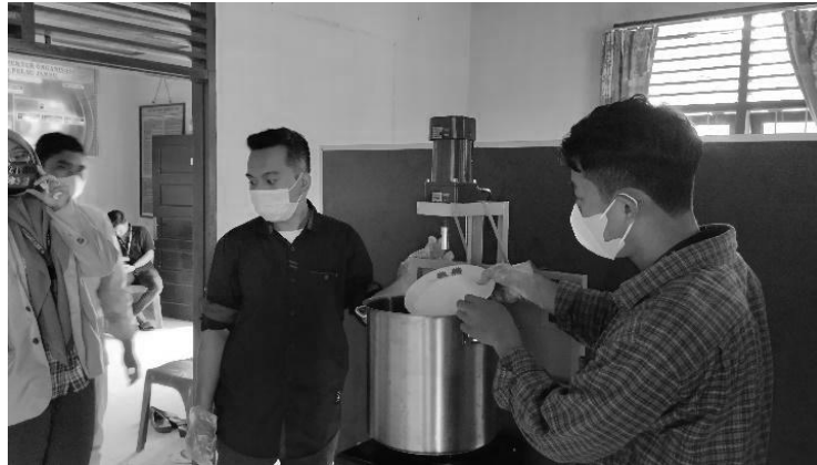
Gambar 5. Pembuatan minuman sari buah jeruk dan nanas menggunakan mesin pengaduk semi otomatis
