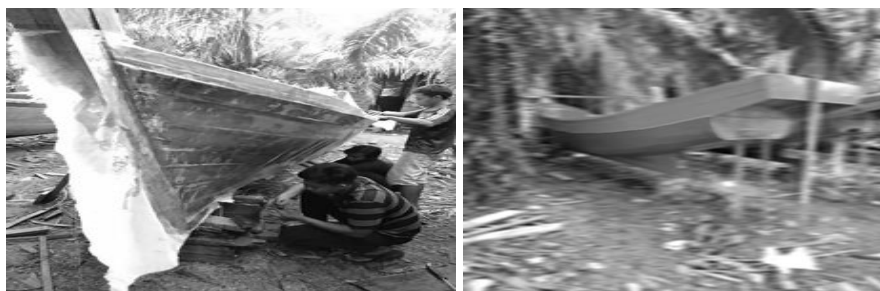
Gambar 3. Workshop Proses Coating Pada Kulit Lambung Kapal Kayu
