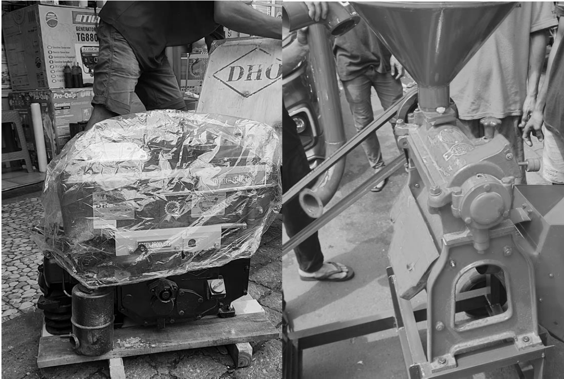
Gambar 6. Alat penggiling padi yang telah jadi dan setelah dipasangkan ke mesin 17 HP diesel.
