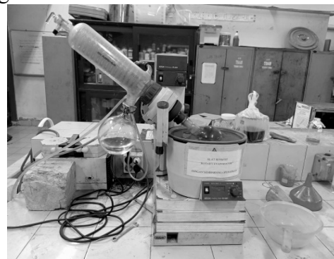
Gambar 8. Daun kersen kemudian dilakukan evaporasi. Evaporasi dilakukan menggunakan rotari evaporator pada suhu 60°C untuk mendapatkan larutan yang kental
