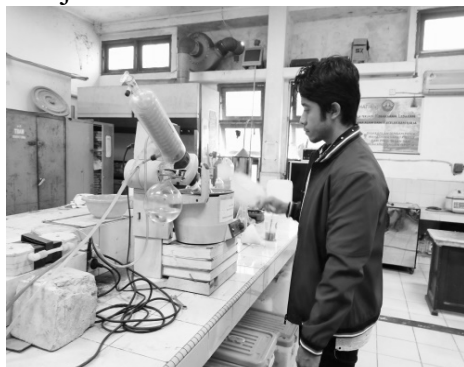
Gambar 8. Daun kersen kemudian dilakukan evaporasi. Evaporasi dilakukan menggunakan rotari evaporator pada suhu 60°C untuk mendapatkan larutan yang kental
