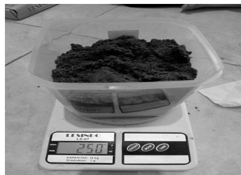
Gambar 6. Daun kersen yang telah diblender, kemudian diayak menggunakan saringan, agar mendapatkan partikel bubuk daun kersen yang lebih halus
