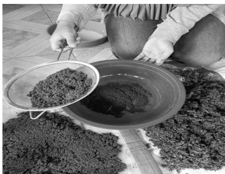
Gambar 6. Daun kersen yang telah diblender, kemudian diayak menggunakan saringan, agar mendapatkan partikel bubuk daun kersen yang lebih halus
