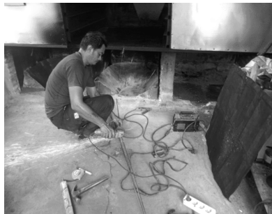
Gambar 2. Proses pengelasan alat inovasi teknologi untuk penyalaihan ikan
