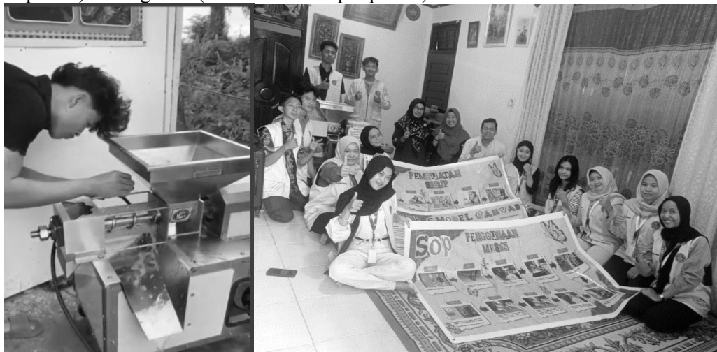
Gambar 4. Uji coba mesin ekstraksi nenas tipe semi-otomatis oleh peserta pelatihan.
