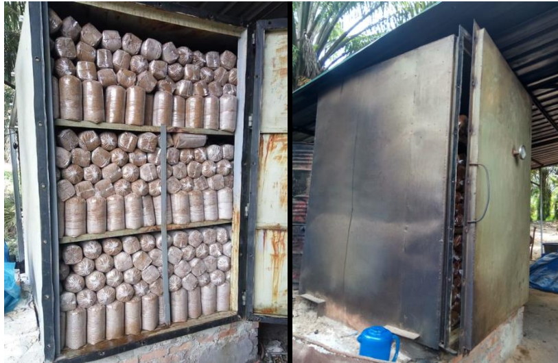
Gambar 3. Alat sterilisasi baglog dengan kapasitas 500 buah baglog
