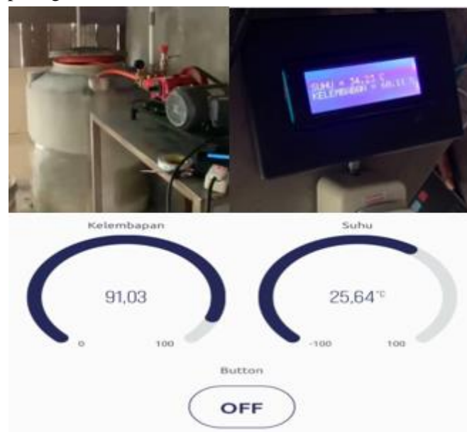
Gambar 2. Tampilan finalisasi fisik alat penyiraman otomatis dan tampilan pada aplikasi blynk
