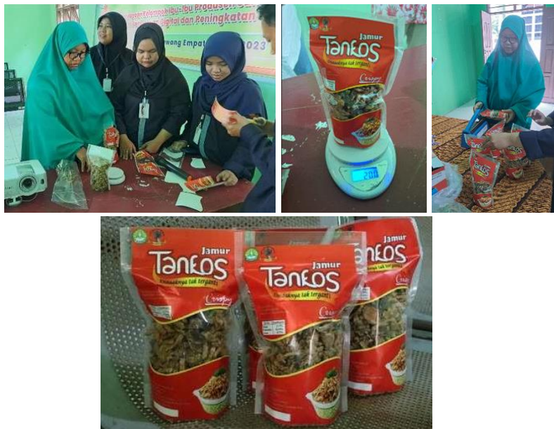
Gambar 4. Proses Pengisian, Penimbangan, dan Perekatan Plastik Kemasan
